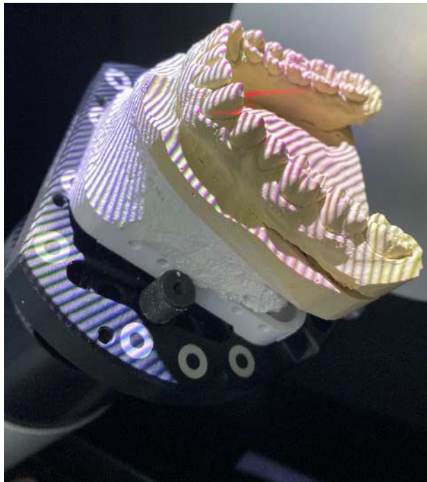
Abb. 18: Während des Scanvorgang sichtbares Streifenlichtmuster auf dem Gipsmodell (Eigene Aufnahme)
