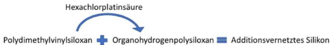
Abb. 24: Additionsreaktion der Basis- und Katalysatormasse von A-Silikon
