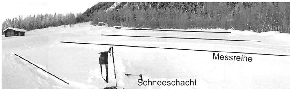
**Foto 2** Beispielhafte Messanordnung auf einer Schneetestfläche. (Entlang der gekennzeichneten hangparallelen Messreihen wurden die Schneetiefenmessungen durchgeführt. Im Schneeschatz wird das SWE bzw. die Schneedichte gemessen.)
