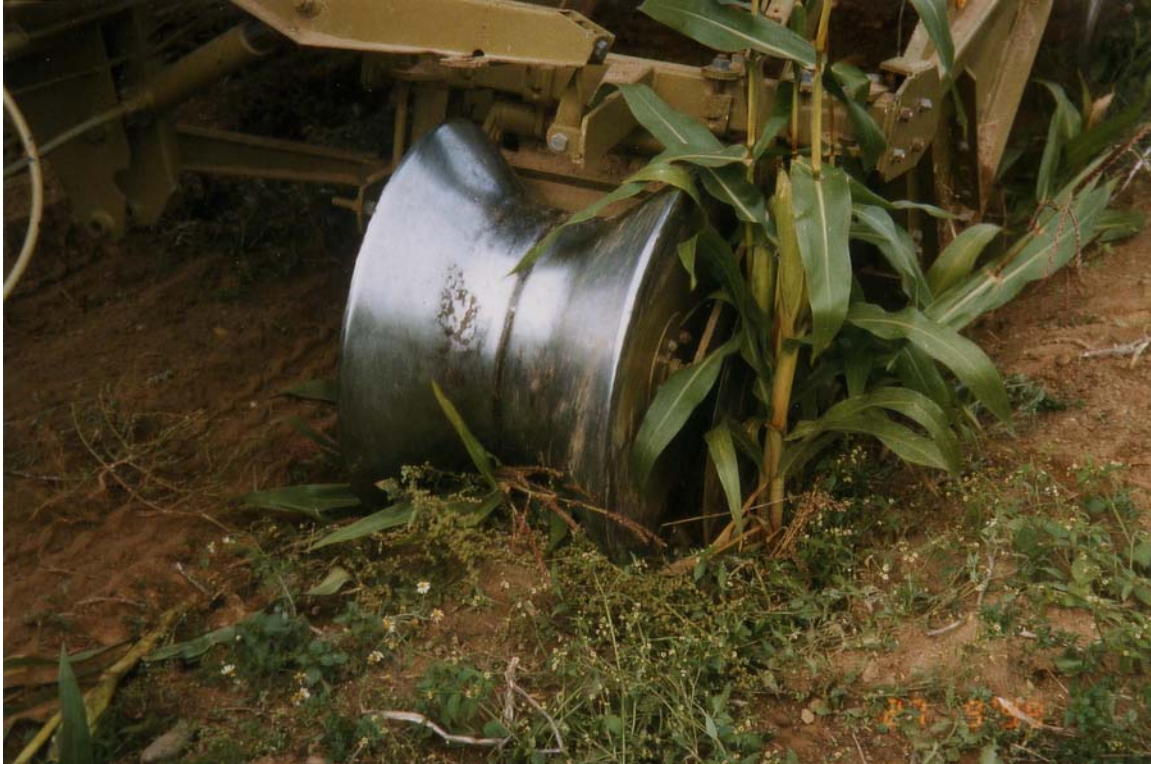
Abb. 5.5: Nahaufnahme Dammführungsrolle neben Maispflanze
