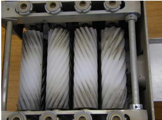
Bild 3-1: Aufsicht Flachsbrecher
