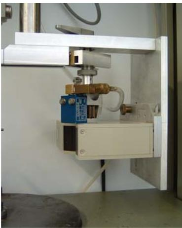
**Bild 3-3:** Laserdiameter zur Querschnittsmessung der Faserbündel
