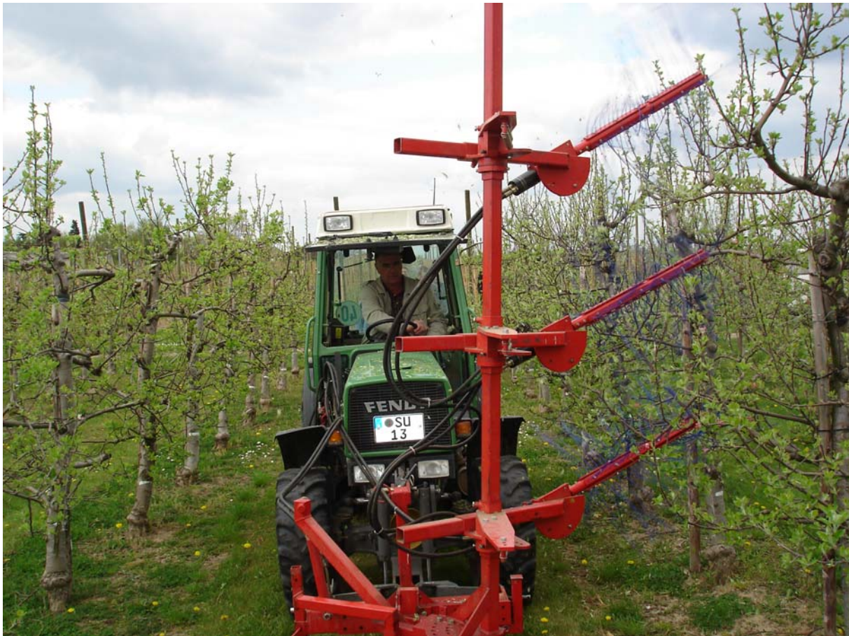
Abb. 1: Einsatz des Gerätes zur mechanischen Fruchtbehangsregulierung
