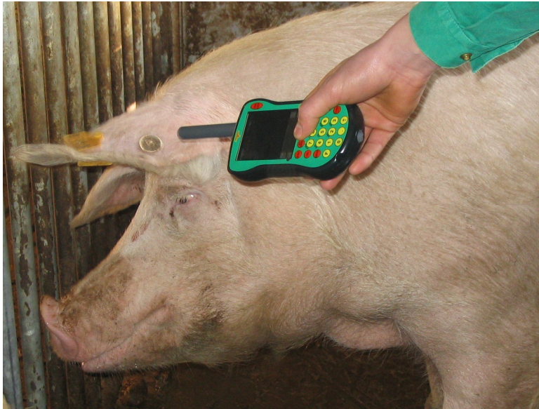
Abbildung 2: Spritzwasser-geschützte Hand-Held PCs sind in Betrieben der Ferkelerzeugung im Einsatz, mit der Möglichkeit auch elektronische Ohrmarken einlesen zu können (Quelle: Firmenunterlagen der Fa. Mannebeck).
