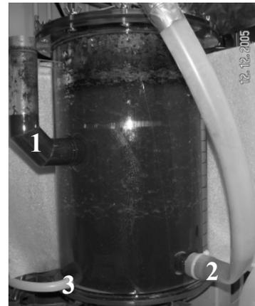
**Abbildung 4: kontinuierlicher Reaktor, befüllt.** Zu sehen sind Zulauf (1), Ablauf (2) und Zulauf des Heizwassers (3).
