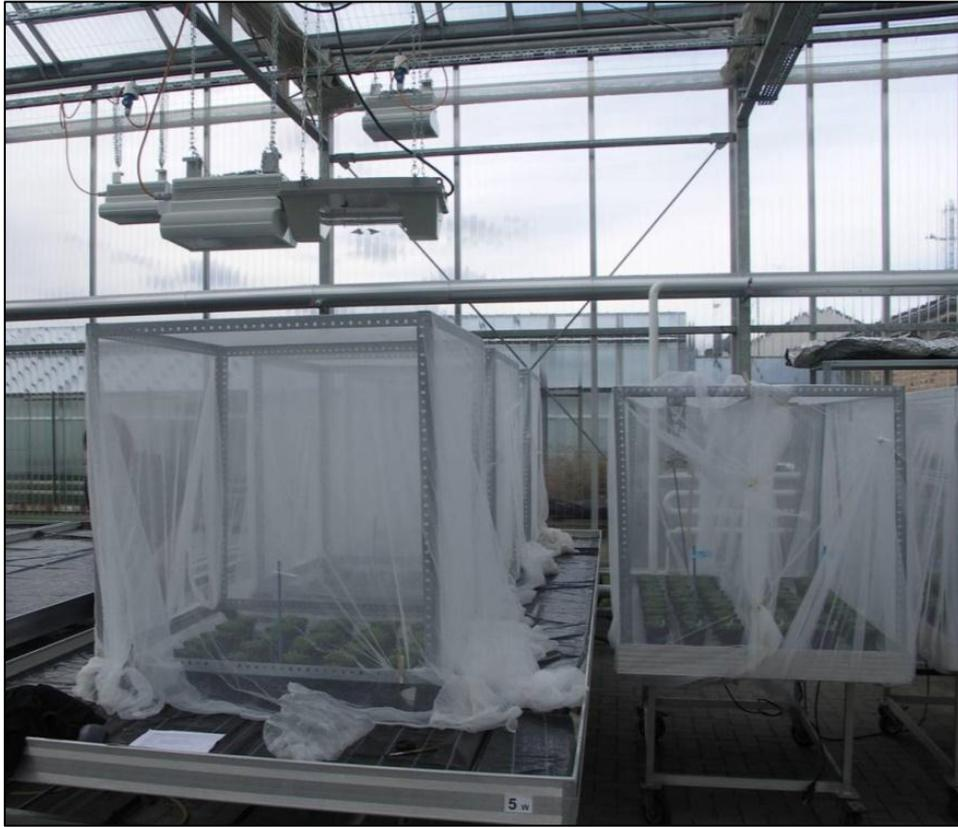
**Abb. 16: Versuchskäfige mit unterschiedlichen Beleuchtungssystemen, hier: Natriumhochdruckdampflampe, LLH, Geisenheim, 2013**
