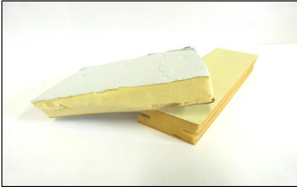
Abbildung 25: Aufnahme verschieden beschichteter Polyurethandämmstoffe (DANGUILLIER, 2015)
