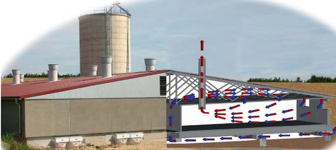
Abbildung 13: Luftführung bei dem Erdwärmetauscher „Opti-Klima“ (Modulstall) der Firma ACO Funki GmbH (DLG, 2008)
