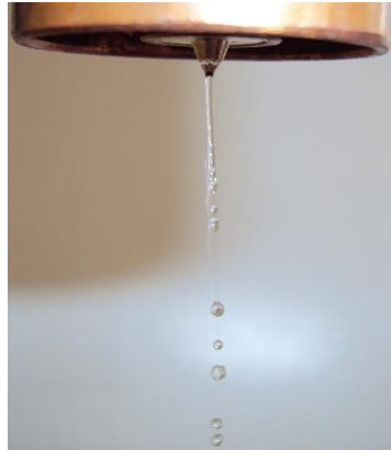
Abb. 24: Ungleichmäßige Tropfenfolge bei 0,5 mm Düsenlochdurchmesser
