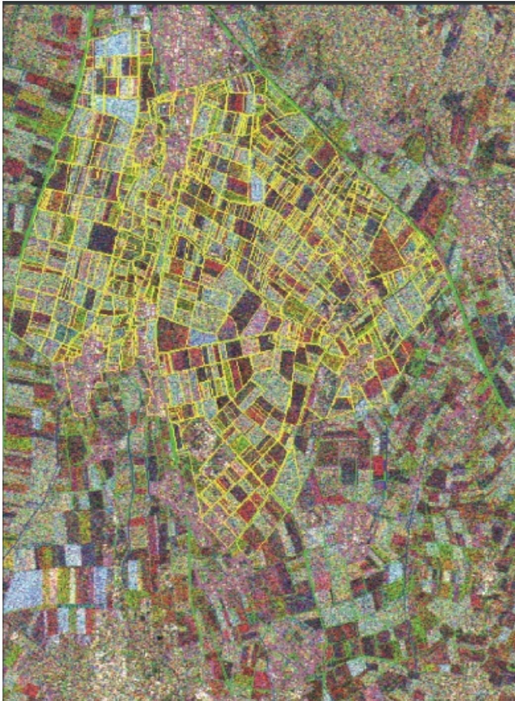
Abb. 5.5: Dreifarbenkomposit dreier ERS-2-Intensitätsbilder; blau: 8. Mai 1997, grün: 12. Juni 1997, rot: 17. Juli 1997. Überlagert mit GIS-Vektoren: ATKIS-Daten (grün: Verkehrswege; blau: Gewässer; rosa: Siedlung) sowie der Flächennutzung (gelb: Schlaggrenzen)
