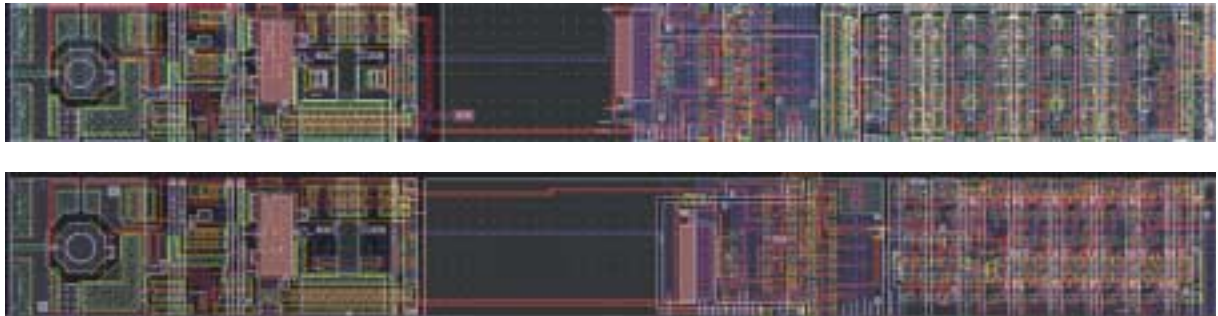
Abbildung 3-3: Layout eines Pixels des Bier&Pastis Chips (oben) und des MPEC 1 Chips (unten)
