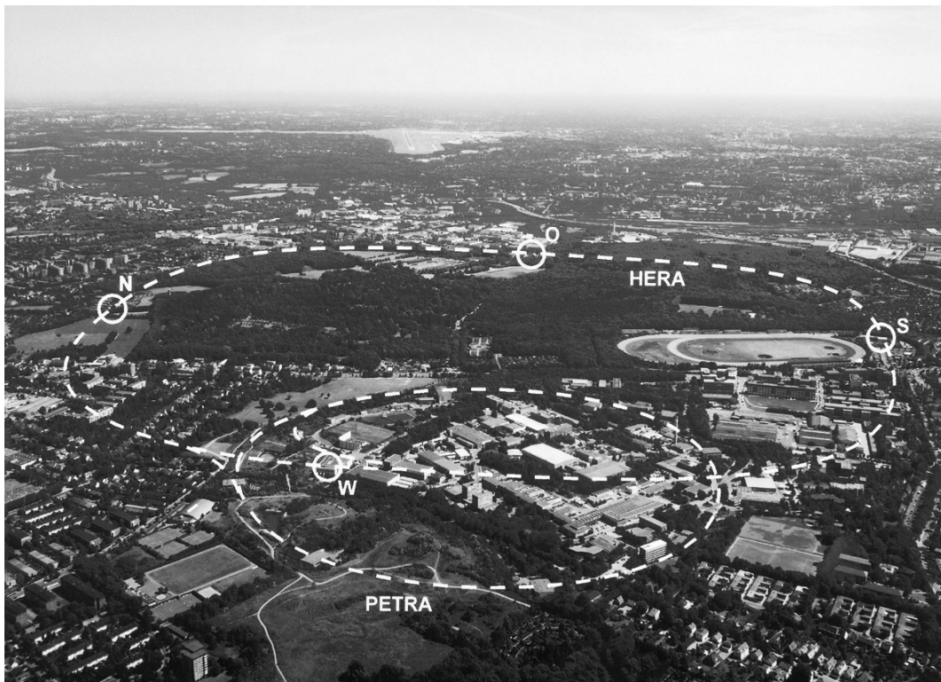
Abbildung 3.1: Die H adron- E lektron- R ing- A nlage bei DESY in Hamburg-Bahrenfeld ist ein über sechs Kilometer Umfang messender Lepton-Proton-Collider, der den Volkspark umfassend in etwa 20 m Tiefe gebaut wurde. Auf dem Photo sieht man neben der großen Beschleunigeranlage noch das DESY-Gelände, den zu HERA gehörigen Vorbeschleuniger PETRA, die Trabrennbahn Bahrenfeld und im Hintergrund den Flughafen Fuhlsbüttel.
