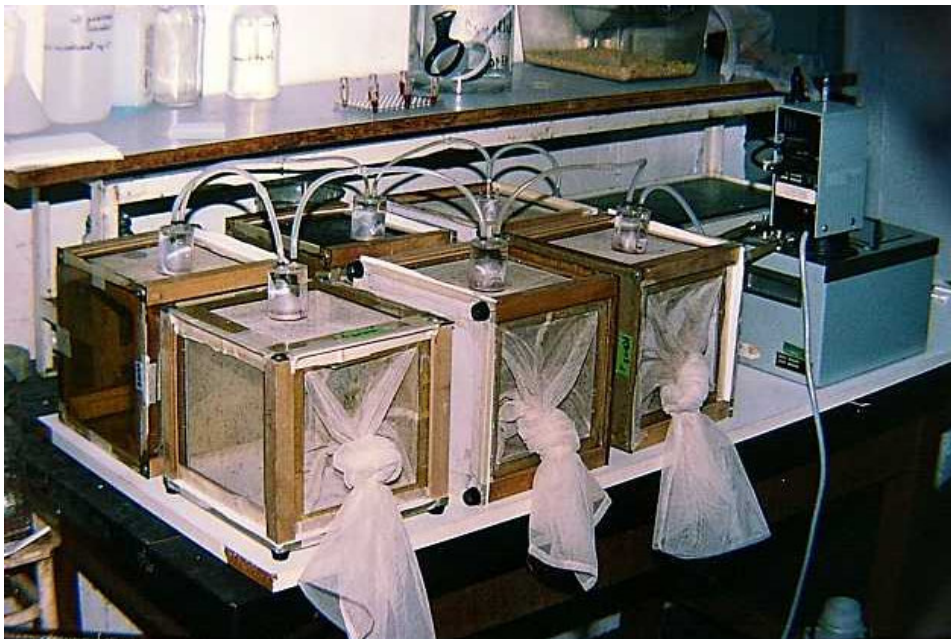
Abb. 6: Die Membranfütterungsanlage bestand aus einer Warmwasserpumpe, mehreren Fütterungskammerchen und an die Pumpe angeschlossenen Schläuchen. Die Fütterungskammerchen waren jeweils an ihrer Unterseite mit einer Paraffinmembran überzogen. Die Wasserpumpe hielt das fließende Wasser auf 38°C, damit das in eine Schicht zwischen unterer Kammerfläche und der Membran eingespritzte Blut auch warm bleiben konnte.
