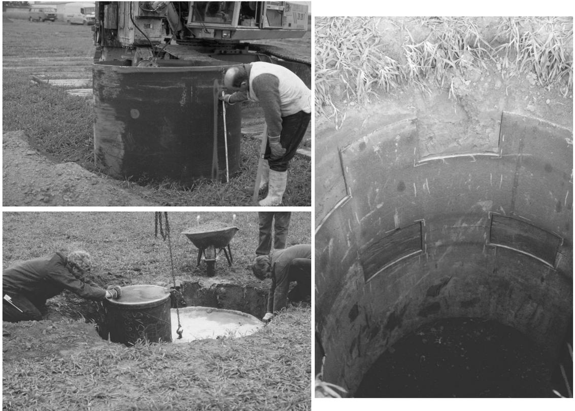
**Abb. 3.1:** Einbau der Beprobungsnester in den Boden: Links oben: Versenkung der Stahlröhre durch einen Bagger mit Rüttelvorsatz; rechts: Versenkte Stahlröhre mit ausgeschnittenen Fenstern; links unten: Aufsetzen des mit Vlies ausgelegten Deckels mit Einstiegs Luke auf ein Stahlrohr.
