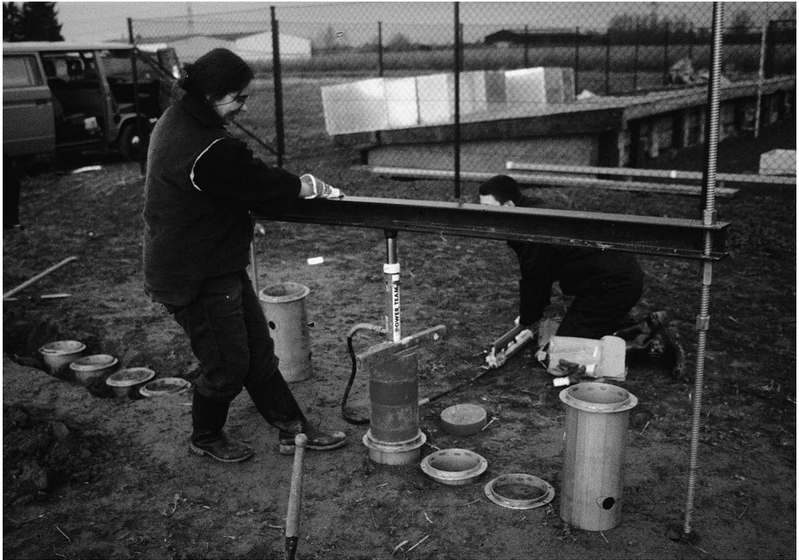
**Abb. 2.1:** Entnahme der ungestörten Bodensäulen im Feld: Senkrecht Eintreiben durch einen Hydraulikzylinder mit einem mit Bodenankern fixierten Doppel-T-Träger als Widerlager. Danach: Freigraben, Abstechen des Bodens unterhalb der Säule, Transport ins Labor, Präparieren eines ebenen unteren und oberen Randes der Bodensäule, Einbau in die Apparatur.
