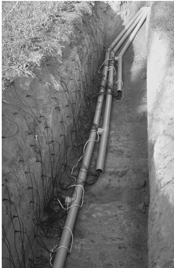
**Abb. 3.7:** Einbau der 21 Bodentemperatur- und 102 TDR-Feuchtesensoren im Trench am Feldversuchsstandort Merzenhausen.
