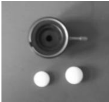
Abbildung 3.4.3 Reflexionsmessung von Tabletten mittels Lichtleitersonde und Irisblende
