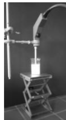
Abbildung 3.3.1 Reflexionsmessung von Pulvern mittels Lichtleitersonde
