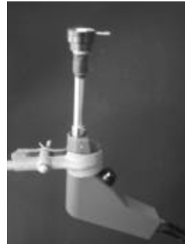
Abbildung 3.4.3 Reflexionsmessung von Tabletten mittels Lichtleitersonde und Irisblende
