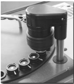
Abbildung 3.4.4 Transmissionmessung von Tabletten mit Vector 22/N-T (Bruker Optik GmbH)
