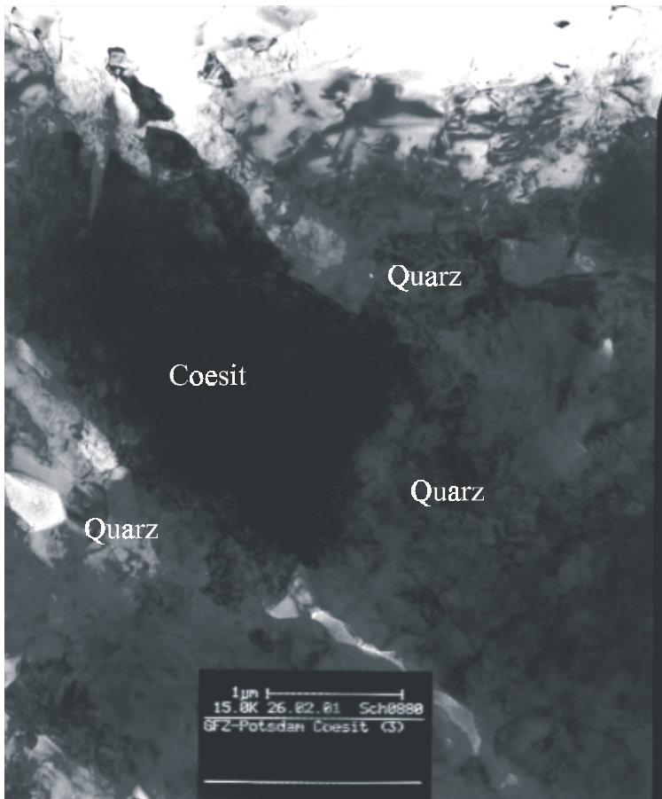
Abb. 56: Dunkelfeld-TEM-Aufnahme. Der dunkel erscheinende Coesit im Zentrum ist von zahlreichen, hellen Quarzkristalliten umgeben. Die Fläche des Coesit-Kristalls beträgt ca. 1 \mu\text{m} \times \mu\text{m} . Die Flächen der Quarzkristallite sind maximal 500 \text{ nm} \times 200 \text{ nm} . Die Versuchsbedingungen der Coesit \rightarrow Quarz-Synthese betragen 22 kbar, 900^\circ\text{C} , bei 20 Minuten Versuchsdauer (vgl. Tab. 13). Der Coesit wurde mit Hilfe von Elektronenbeugung identifiziert.
