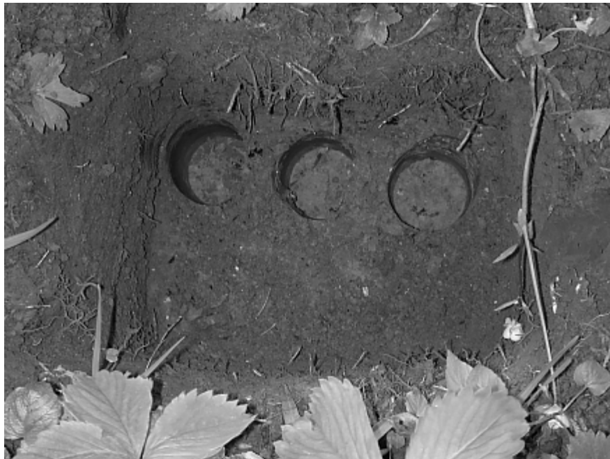
Abb. 9: Ansicht einer Probennahmestelle für ungestörte Bodenproben. Die oberste Bodenschicht ist bereits abgetragen worden. Für die nachfolgende Bodenschicht sind drei der insgesamt sechs Bodenproben bereits entnommen worden.
