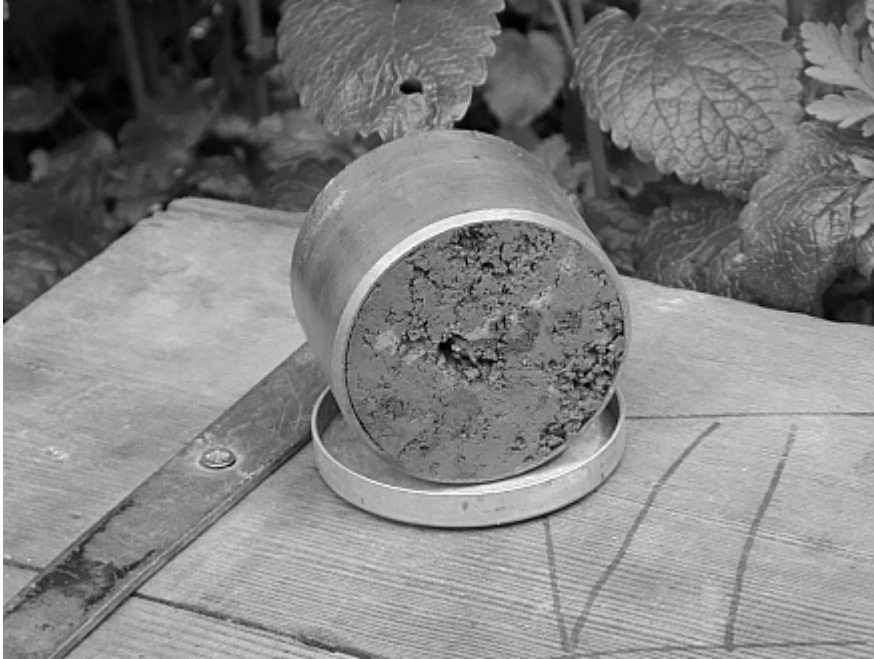
Abb. 8: Eine ungestörte Bodenprobe in einem Stechzylinder.
