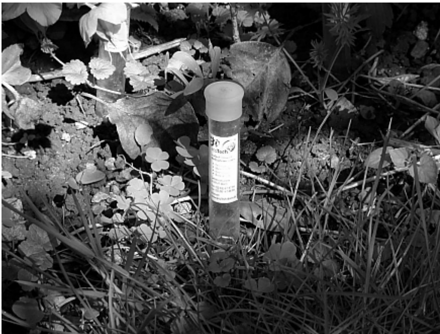
Abb. 10: Ein im Boden installiertes mechanisches Tensiometer.
