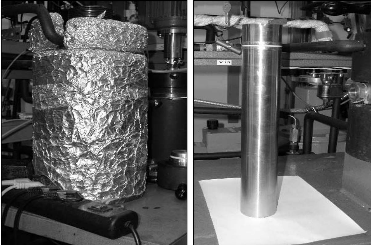
Abbildung III-4: Extraktor (links) mit Extraktionsbehälter (rechts) der Hochdruckanlage im Fraunhofer ICT, Pfinztal
