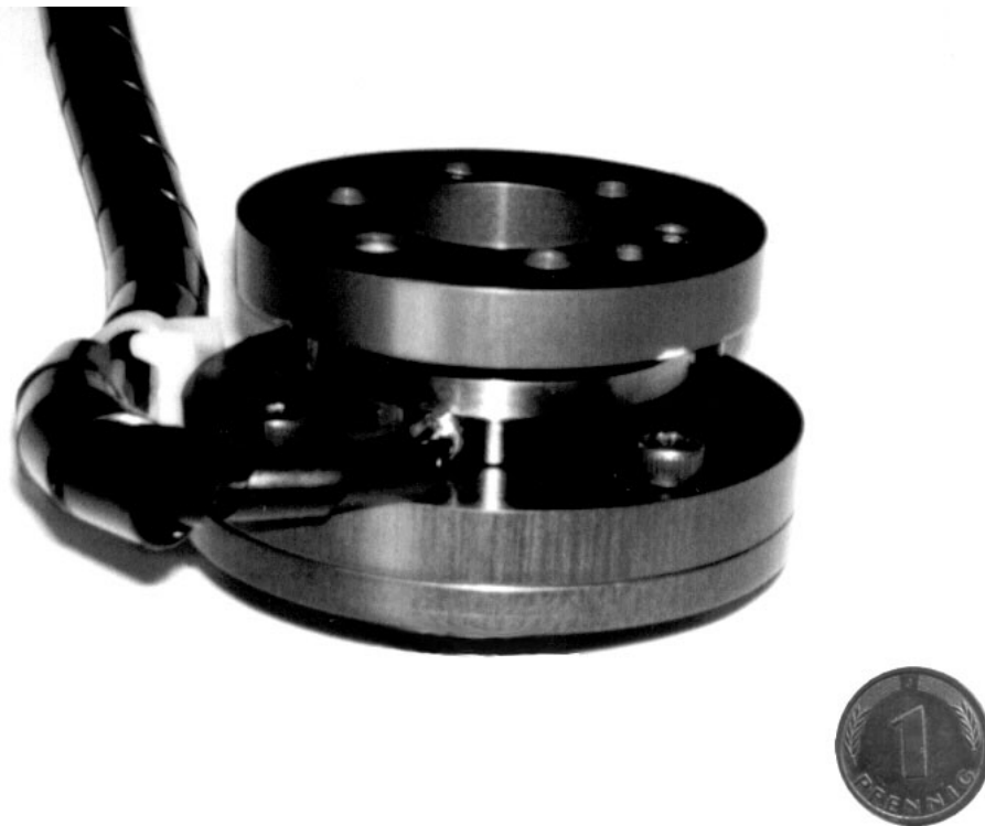
Bild 7.31: Bisher verwendeter Kraft-/Momenten-Sensor (Firma ATI) auf den nun verzichtet werden kann.
