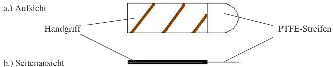
Abb. 3-1: Aufsicht und Seitenansicht eines Lyophilisatträgers.
