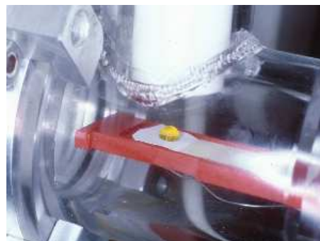
Abb. 3-6: Detailaufnahmen des noch flüssigen Tropfens in der Trockenkammer. (Tropfen ist noch durchsichtig). Foto: M Diestelhorst.
