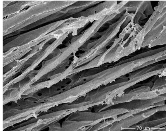
Abb. 4-45: Detailaufnahme der langen, dünnen Eiskanäle auf der Unterseite.
