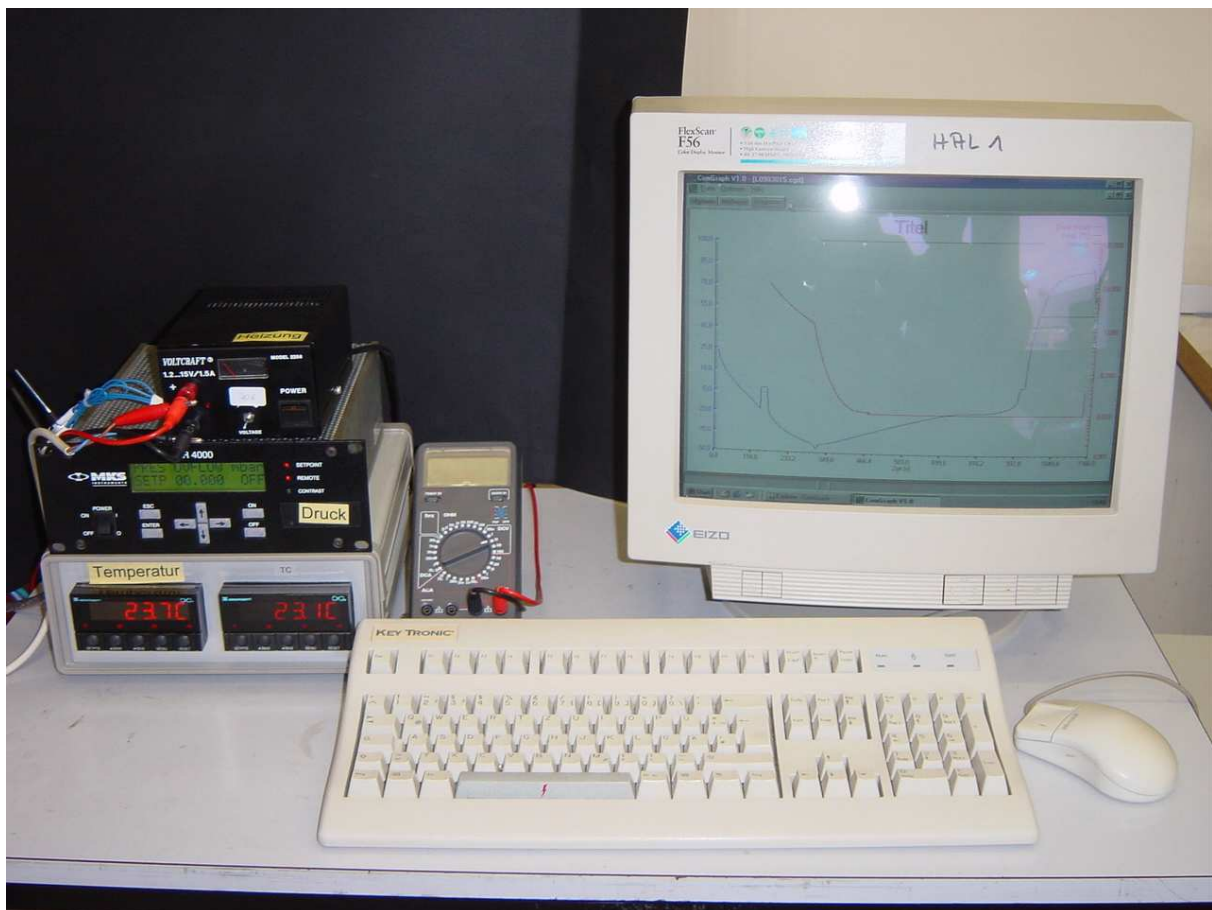
Abb. 4-11: Erfassung und Aufzeichnung von Druck und Temperatur.
