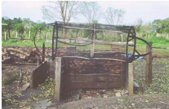
**Abb. 2-4:** traditionelle Zapekierweise im Drahtkorb über offenem Feuer
