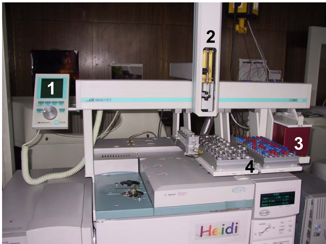
Abbildung 4: Mehrzweckprobengeber CombiPAL der Firma CTC Analytics, montiert auf einem Gaschromatographen (Modell 6890 Serie II Plus) der Firma Agilent (1 = Bedienpanel, 2 = beweglicher Roboterarm, 3 = Agitator, 4 = Halter für Probenvials).
