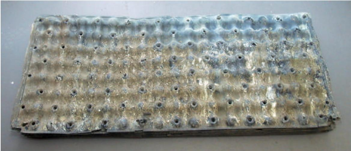
Bild 4.4.1.3: Ausgebaute Einzellamelle aus dem Tropfenabscheider eines RKW's. Deutlich sichtbar sind die (jetzt getrockneten) Beläge auf der Oberfläche
