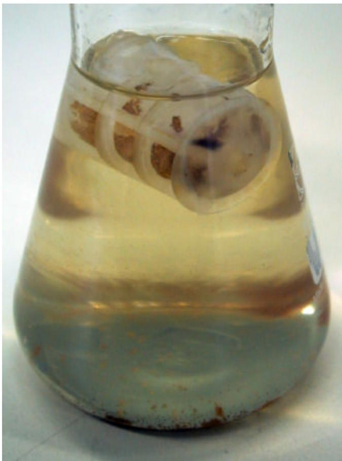
Bild 4.5.1: EingangsfILTER einer zahnärztlichen Behandlungseinrichtung. Deutlich sichtbar sind die schleimartigen Ablagerungen, aus denen Legionellen isoliert werden konnten. Unten: Vom Filter abgelöste partikuläre Sedimente
