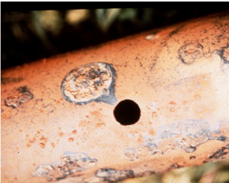
Bild 4.1.9.2.1: Lochkorrosion in einem Kupferrohr einer Trinkwarmwasser-Hausinstallation
