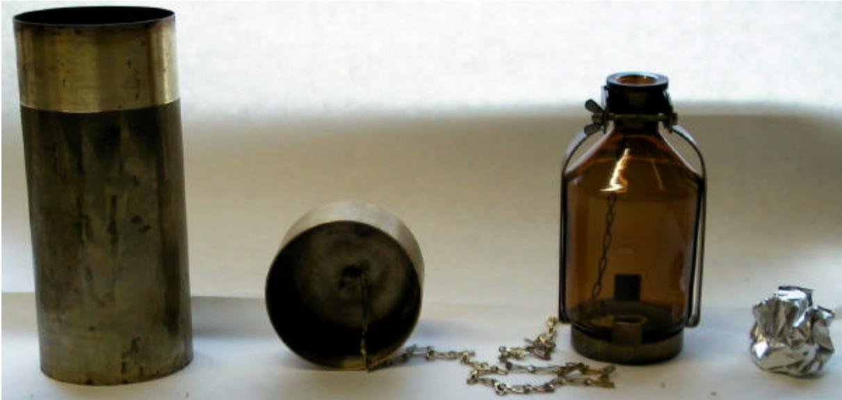
Abb. 2.1.2.3: Tauchflasche zur sterilen Entnahme von Schöpfproben
