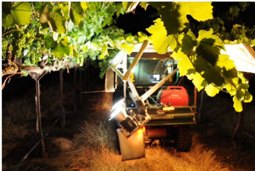
Abbildung 2.2: Die Sensorplattform aus Nuske et al. [2014b] im Feldeinsatz bei Nacht (modifiziert).
