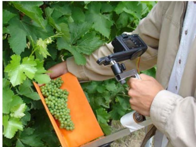
Abbildung 2.3: Der tragbare Sensor aus Rabatel and Guizard [2007] mit künstlichem Hintergrund im Feldeinsatz (modifiziert).
