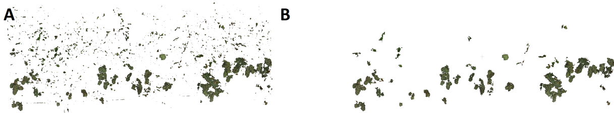
Abbildung 4.34: A: 3D-Punkte, die der Klasse Traube zugewiesen wurden. Kleine, unstrukturierte Punktregionen sind zum Großteil Fehlklassifikationen. B: Das CC-Verfahren entfernt alle Komponenten mit einer Punktzahl < p_K . Dadurch wird der Großteil der falsch klassifizierten Punkte entfernt, während der Großteil der korrekt klassifizierten Punkte erhalten bleibt, aus Rose et al. [2016].
