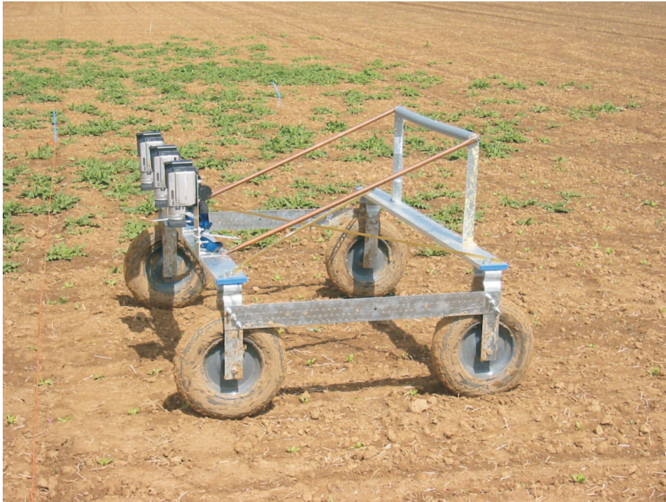
Abb. 5.2: Der WEEDSCANNER auf einer Zuckerrübenfläche am Versuchsgut Klein-Altendorf bei Meckenheim. Die digitalen Camcorder sind auf einer Montageleiste flexibel befestigt und nehmen kontinuierlich Videosequenzen der Ackeroberfläche auf.
