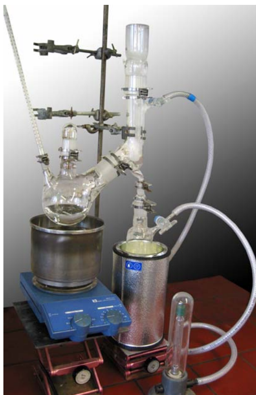
Abb. V.1.4: Zur Abdestillation des (schwerer flüchtigen) Di( n -butyl)ethers benutzte Apparatur.
