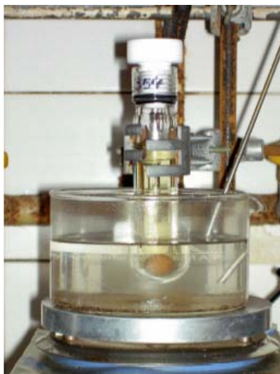
Abbildung 63: Versuchsaufbau für die Synthese von Trimethyl-(2phenoxy-ethyl)-ammoniumbromid 42
