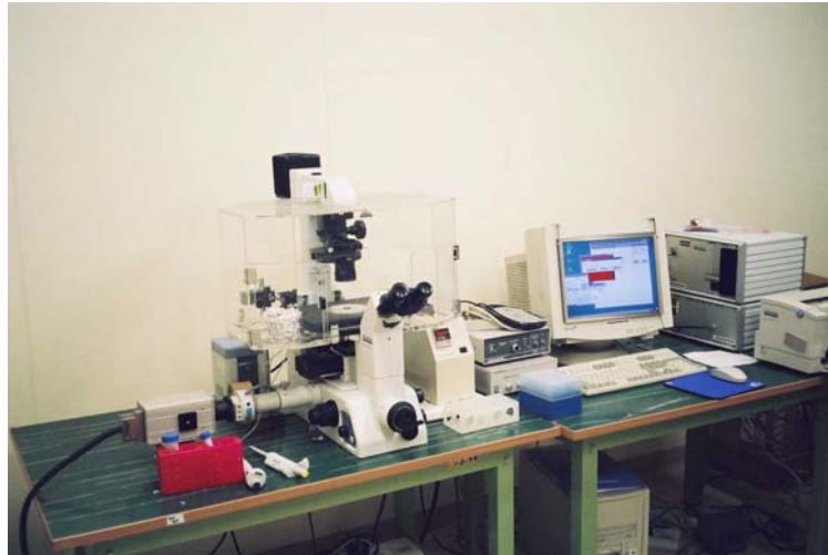
Abbildung 132: Versuchsaufbau von links nach rechts: Lichtquelle, Mikroskop mit Inkubator; Steuerungselement des Inkubators; Kamerakontroller & PC
