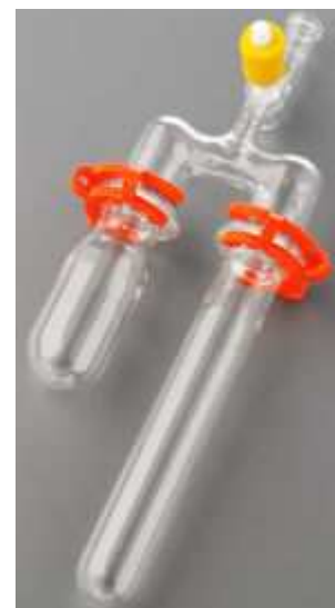
Abbildung 4-5: Darstellung der Gefriertrocknungseinheit.
