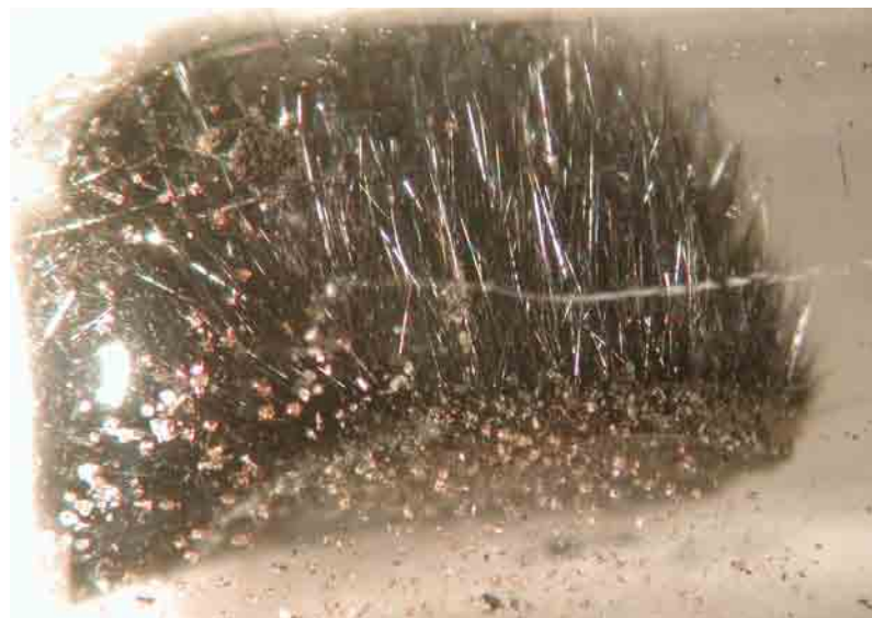
Abbildung 3-41: Vom Kern eines Eduktpresslings ( \varnothing = 6 mm) abgelöster Kristallrasen aus \text{Cu}_{1-x}[\text{W}_2\text{O}_2\text{Cl}_6] -Nadeln, fotografiert durch die Wand der Reaktionsampulle. An dieser anhaftend Kristalle von \text{WO}_2\text{Cl}_2 .
