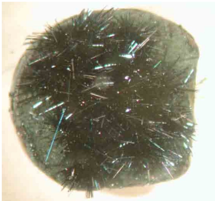
Abbildung 3-64: Nadeln von \text{Ag}_{1-x}[\text{W}_2\text{O}_2\text{Cl}_6] , auf einem Eduktpressling ( \varnothing = 6 \text{ mm} ) aufgewachsen.
