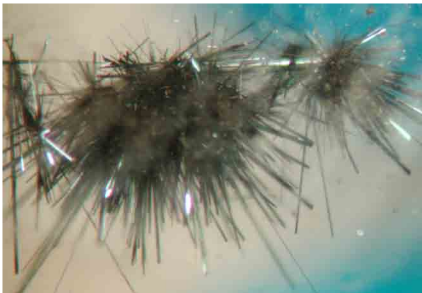
Abbildung 3-63: \text{Ag}_{1-x}[\text{W}_2\text{O}_2\text{Cl}_6] -Kristalle, an der Ampullenwand anhaftend. Der Eduktkuchen, aus dem sie entstanden sind, wurde in den freien Raum angehoben.
