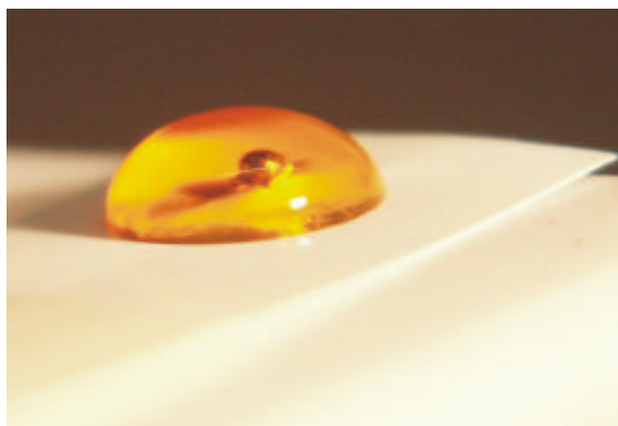
Abb. III-12: Thermoelement eingebettet in den Tropfen auf der Trägerplatte des Verschlusses
