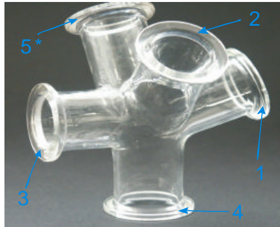
Typ B: für Überwachung der Oberflächentemperatur des Tropfens
