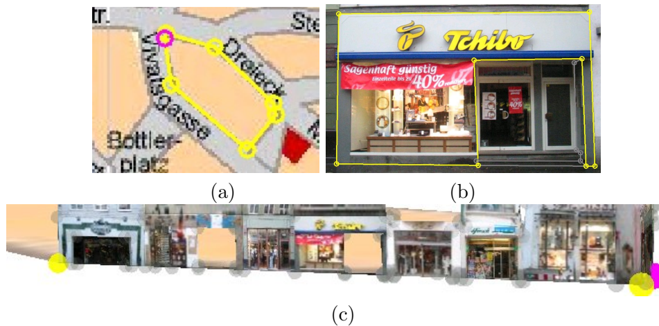
Abbildung 4.28: Grundriss-Beispiel: Aus (a) dem Grundriss und (b) den Fassadenbildern entsteht (c) der interpolierte Grundriss mit Fassade.
