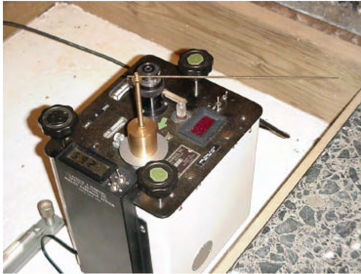
Abbildung D.27: Spindelaufsatz für LCR-Gravimeter
