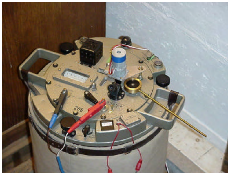
Abbildung D.26: Askania Gravimeter GS15 Nr. 206 mit Spindelmotor und Mikrometerhebel
