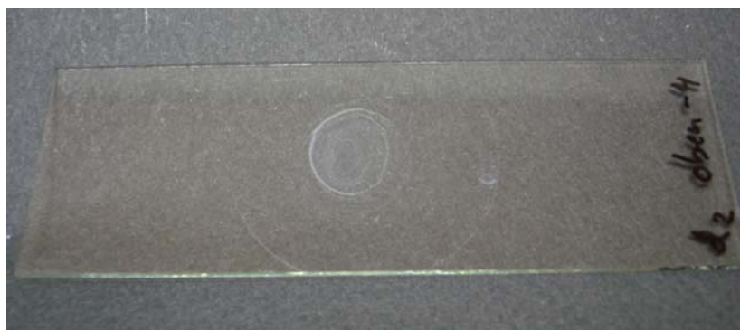
Abb. 1: Ein mit kutikularen Wachsen von der adaxialen Seite von Apfelblättern beschichteter Glasobjektträger.
