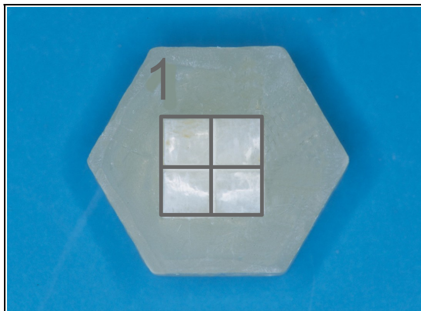
Abb. 24: Darstellung einer in 4 Flächen unterteilten und auf einen Kunststoffsockel befestigten Schmelzprobe.
