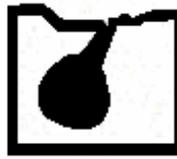
Sackpore bei maximaler Feuchteabsorption nahe 100 % r.F.
