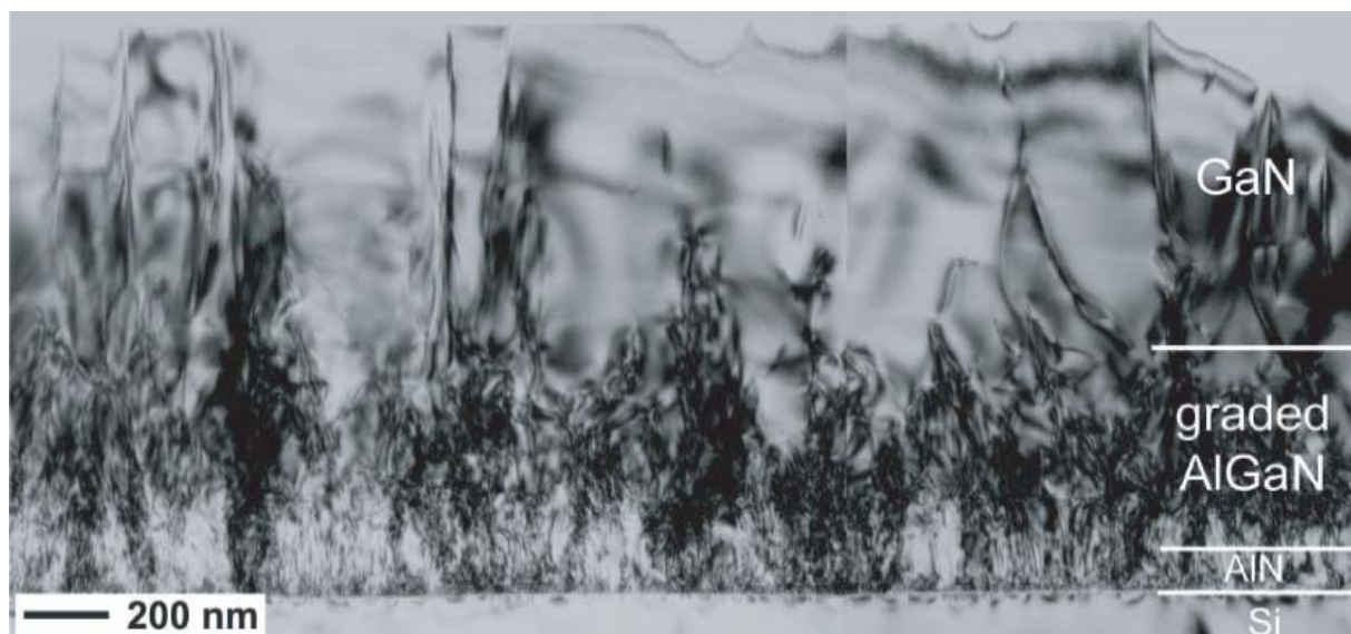
Abbildung 1.8: TEM-Übersichtsaufnahme einer GaN-Schicht auf geordneten AlGaN Puffer. Deutlich ist die starke Abnahme der Versetzungsdichte zur Schichtoberfläche hin zu erkennen [Abl 04].
