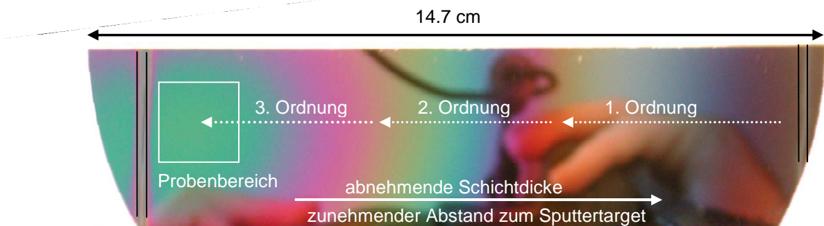
Abb. 3.8: Fotografie eines Siliziumwafers, der mit Aluminiumoxid beschichtet wurde. Der Wafer war mit 30 nm \text{SiO}_2 vorbeschichtet. Man sieht unterschiedliche Interferenzfarben, die man auf eine Variation der Dicke der Aluminiumoxid-Sputterschicht zurückführen kann. Mit zunehmender Schichtdicke werden dabei drei Beugungsordnungen durchlaufen, die markiert sind. Der Probenbereich ist mit einem Quadrat abgegrenzt. Hier beobachtet man eine einheitliche Interferenzfarbe (grün). Daraus schließt man, dass die Dicke der Aluminiumoxid-Schichten über die Probenfläche homogen war. Weiterhin sieht man das Spiegelbild einer Hand des Experimentators. Der Wafer wurde mit zwei Drähten direkt unterhalb der Schattenmaske befestigt. Mit schwarzen Strichen sind die Bereiche markiert, die durch die Drähte verdeckt waren.
