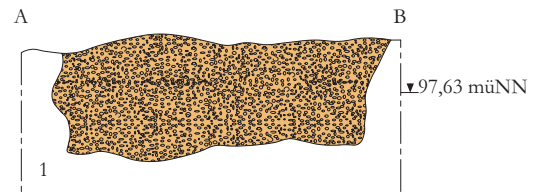
1- anstehender Boden Punktfundament 42 (St. 297) M 1 : 20
