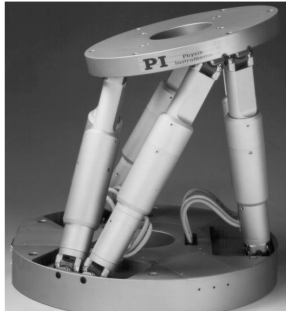
Abbildung 25: Foto eines Hexapoden vom Typ M-850.50, wie er als Belastungseinheit für das HexMeS verwendet wird.
