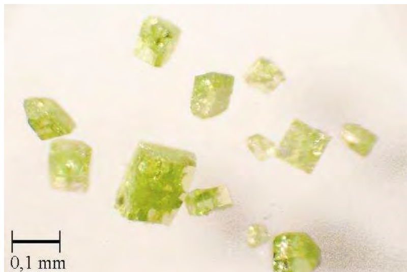
Abbildung 7.1 Kristalle von NiTi_2O_2(PO_4)_2 aus einem Transportexperiment unter Zusatz von PtCl_2 und TiP.
