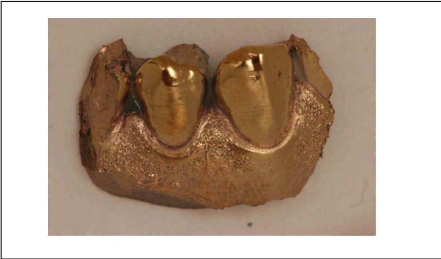
Abb. 6: Aufnahme von Repliken, die mit Gold bedampft wurden
