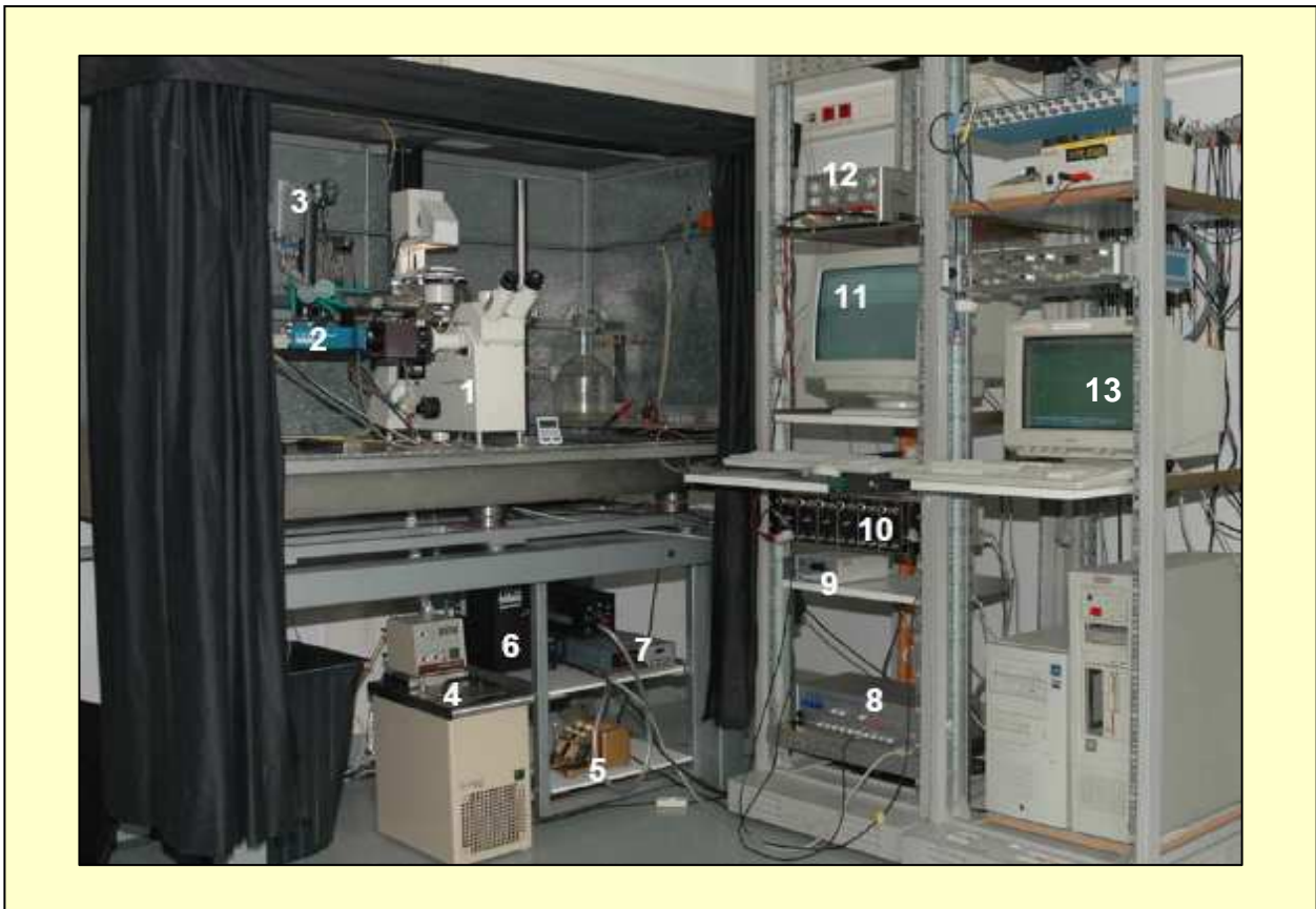
Abbildung 4: Versuchsstand: 1 Mikroskop Axiovert 135 TV, 2 IonOptix Myo Cam, 3 Perfusionsssystem, 4 Julabo F10 Wärmebad, 5 HyoFlo Absaugpumpe, 6 IonOptix HyperSwitch, 7 Transformator für die Xenonlampe, 8 IonOptix Fluorescence System Interface, 9 IonOptix Kamerasteuerung, 10 Verstärker, 11 Kontrollmonitor Datenerfassung, 12 Grass SD 9 Reizgerät, 13 Kontrollmonitor für Reizsteuerung
