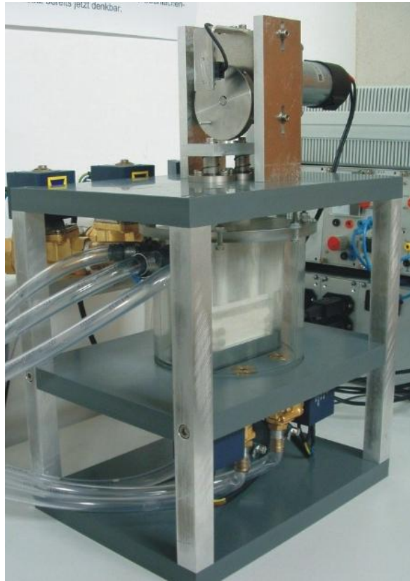
Abbildung 7: Für den Immersionstest verwendeter Versuchsaufbau. Plexiglaszylinder mit Zu- und Ablaufventilen sowie innerer Duranglasbehälter mit Macorstempel.
