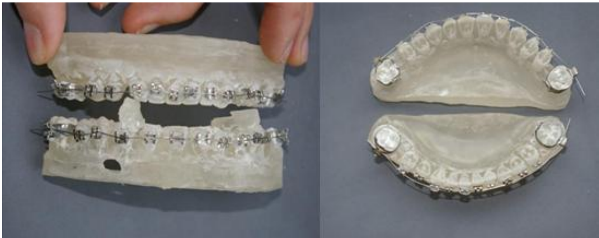
Abbildung 9: Links: Seitliche Ansicht des ersten Kiefermodells mit Brackets, Bändern, Draht und am Modell befestigten Stempeln. Rechts: Aufsicht auf das erste Kiefermodell ohne Stempel.
