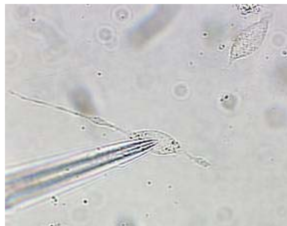
Abbildung 2: Links. Mikroskopische Aufnahme der Pipettenspitze mit Patch vor den „Tubes“ des Lösungs-Applikationssystems. Mit Hilfe des Steuerungsprogramms konnte man in einer experimentellen Sequenz durch Rotation des Drehkopfes die „Tubes“ schwenken, sodass die jeweiligen Lösungen isoliert in Kontakt
