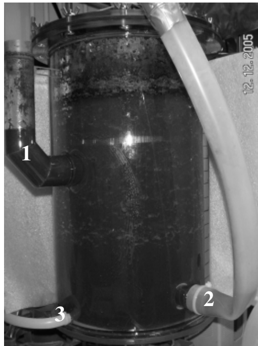
Abb. 3.1: Kontinuierlicher Reaktor, befüllt. Zu sehen sind Zulauf (1), Ablauf (2) und Zulauf des Heizwassers (3). Die Isolation ist aufgeschlagen.
