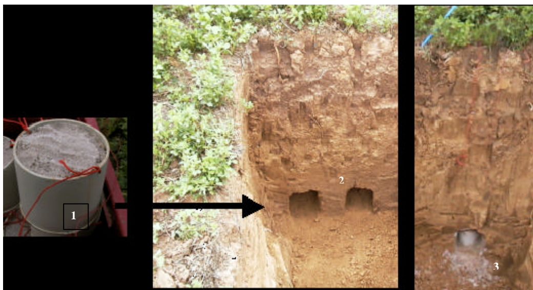
Abbildung 31: (a) NO 3 - -Sammler, (b) Profilgrube mit seitlichen Stollen, die eine Installation unter dem ungestörten Bodenkörper ermöglichen, (c) Installation der Sammler, je vier NO 3 - -Sammler in eine Profilgrube
