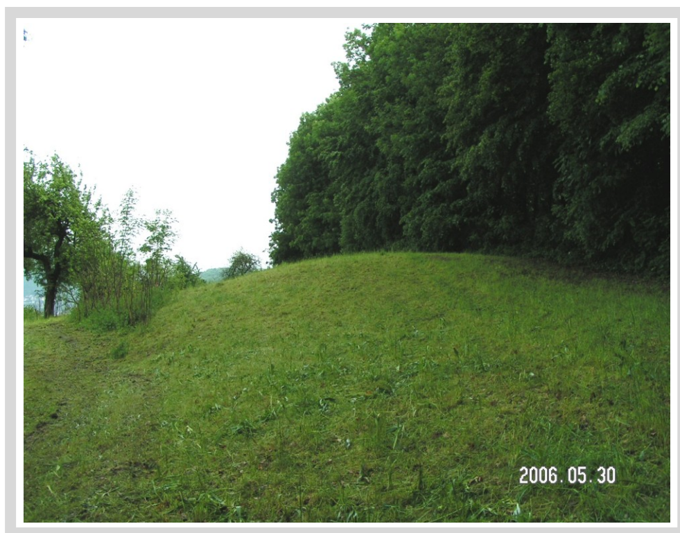
Abbildung 15.14: Fuß einer Rutschung im Seetal / Fils bei Geislingen a. d. St. Die Rutschung konnte auf Grund der Berechnungen des 'Newmark displacement' als Rotationsrutschung identifiziert werden. Die Abrisskante war im Wald im dichten, unzugänglichen Unterwuchs verborgen. Eigenes Foto.
