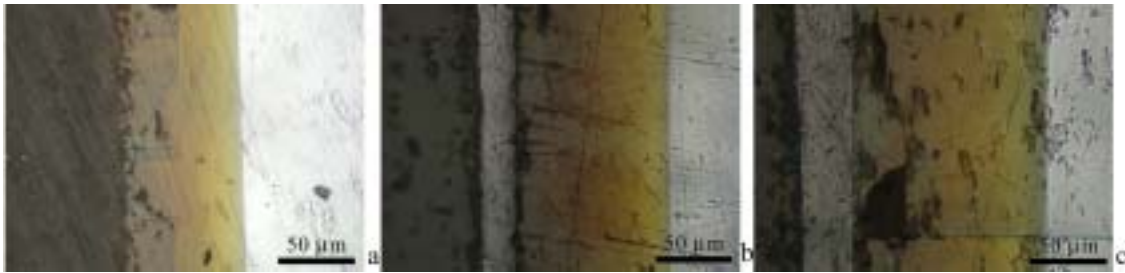
Abbildung 45: lichtmikroskopische Aufnahme der Diffusionszone und der Klebefugen bei den Proben: a) EK05, b) EK1 und c) EK2.
