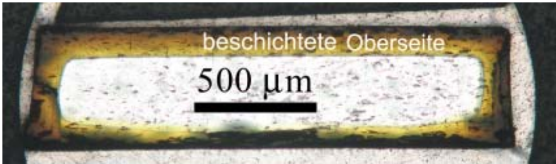
Abbildung 29: gleichmäßige Einwachsfront nach modifizierter Substratfixierung
