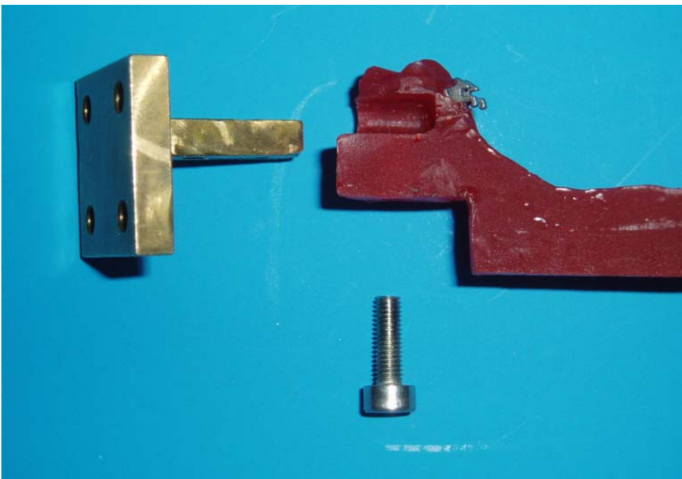
Abb. 20: Detail der Abbildung 18 von der Präparation des Kunststoffmodells aus Palavit G mit der Schraube und zur Befestigung am Messtisch des Messaufbaus.
